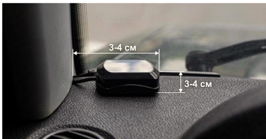
Пример расположения внешней антенны ГЛОНАСС/GPS
