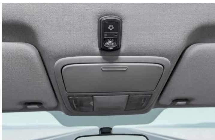
Пример установки БИП в салоне автомобиля
